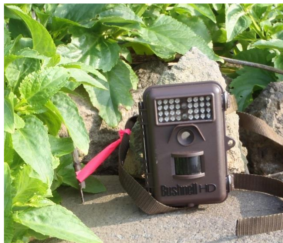
図5 赤外線ライトを搭載した定点カメラ
